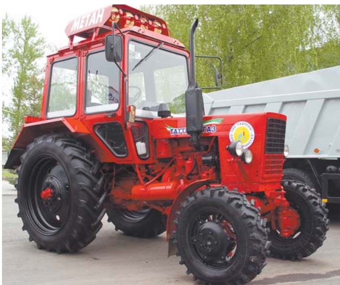
Трактор МТЗ-82 на метане на выставке газобаллонной техники в Казани
