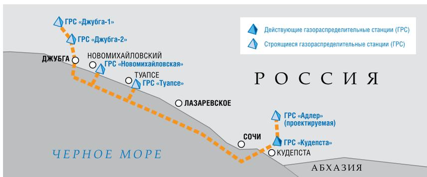
Протяженность газопровода составит 177 км, включая морской участок длиной 159,5 км. Трасса газопровода пройдет по дну Черного моря вдоль прибрежной полосы (на расстоянии примерно в 4,5 км от берега) до газораспределительной станции «Кудепста» вблизи г. Сочи. Диаметр газопровода — 530 мм, ежегодная производительность — около 3,8 млрд куб. м.
