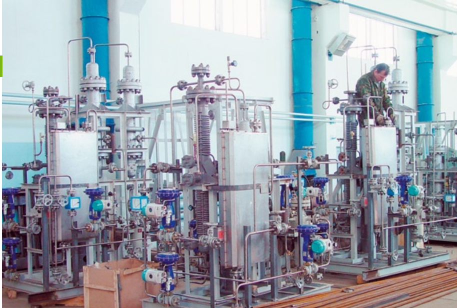
Стенд для отработки технологий синтеза Фишера – Тропша
