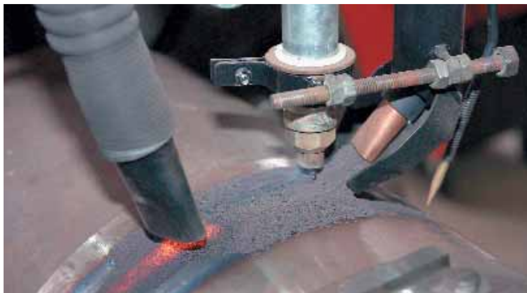
В «ТюменНИИгипрогазе» машины автоматической сварки практически заменили ручной труд
