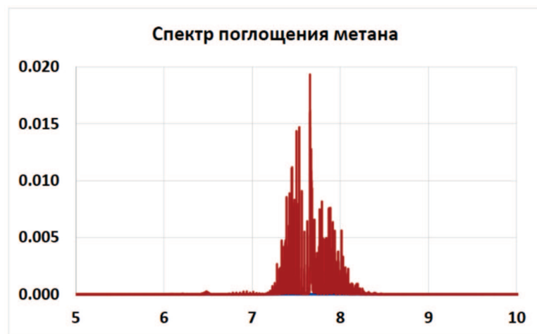
Рисунок 6.7. Спектр поглощения метана в диапазоне длины волны 6,3 – 8,3 мкм: по оси абсцисс – длина волны (мкм); по оси ординат – коэффициент поглощения (относительные единицы)
