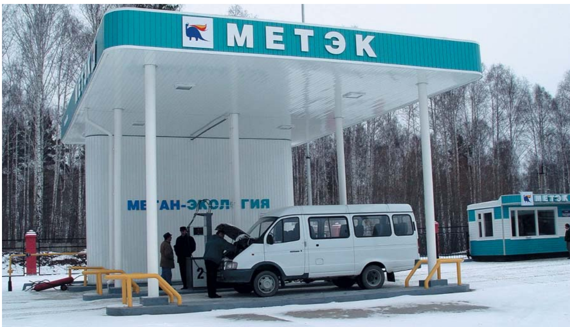
На фото: созданная в ООО «Уралтрансгаз» АГНКС нового поколения Би-70 с гидроэлектрическим приводом на 70 заправок в сутки. Отечественные аналоги отсутствуют
