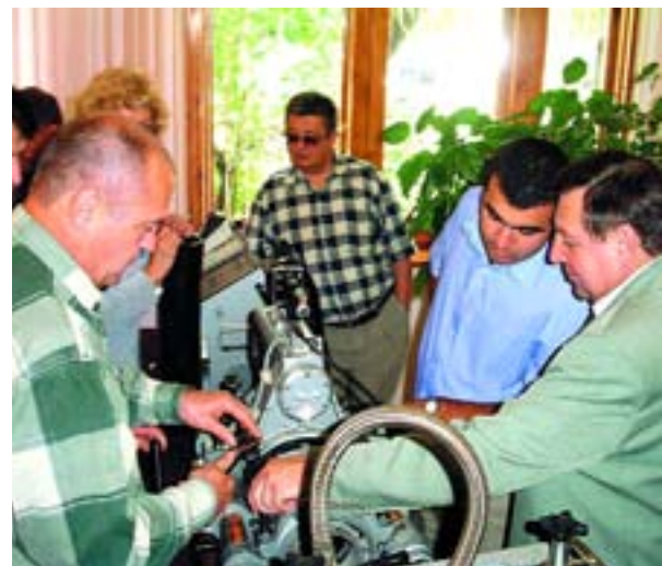
Специалисты института изучают в Госгортехнадзоре РФ агрегат фирмы «Фьюджин» для сварки полиэтиленовых труб встык
