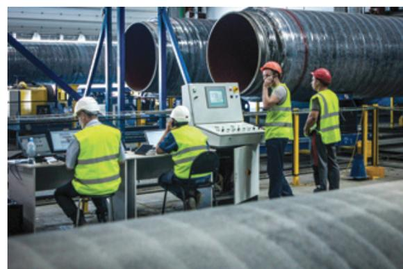
по газопроводу «Северный поток». Благодаря уникальному соотношению диаметра (813 мм) к толщине стенки (39 мм) эта труба способна выдерживать давление до 250 атм. ОМК также поставила соединительные детали для строительства КС «Русская» газопровода «Южный коридор», выдерживающие еще более высокие давления.
