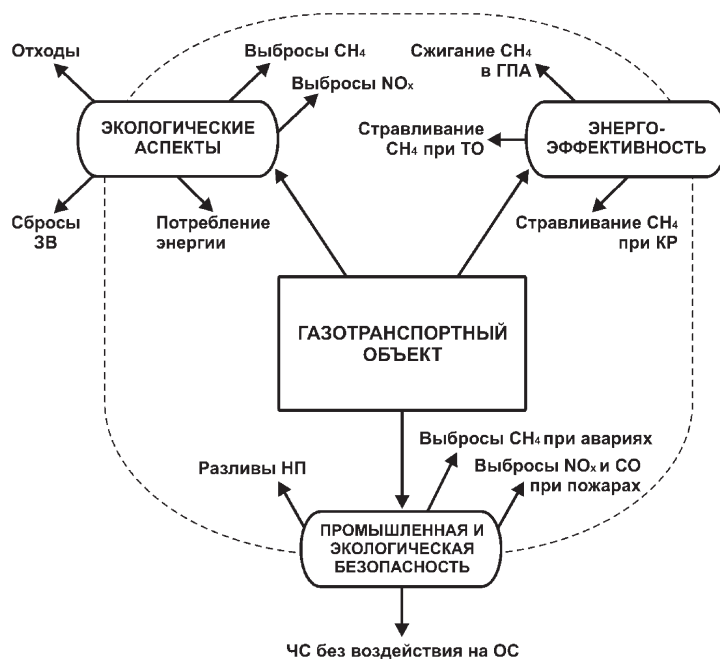
Рис. 16.1. Взаимосвязь экологических аспектов, энергоэффективности, промышленной и экологической безопасности на газотранспортных объектах.
