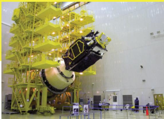
Спутник «Ямал-402» в монтажно-испытательном комплексе с разгонным блоком «Бриз-М», космодром Байконур
