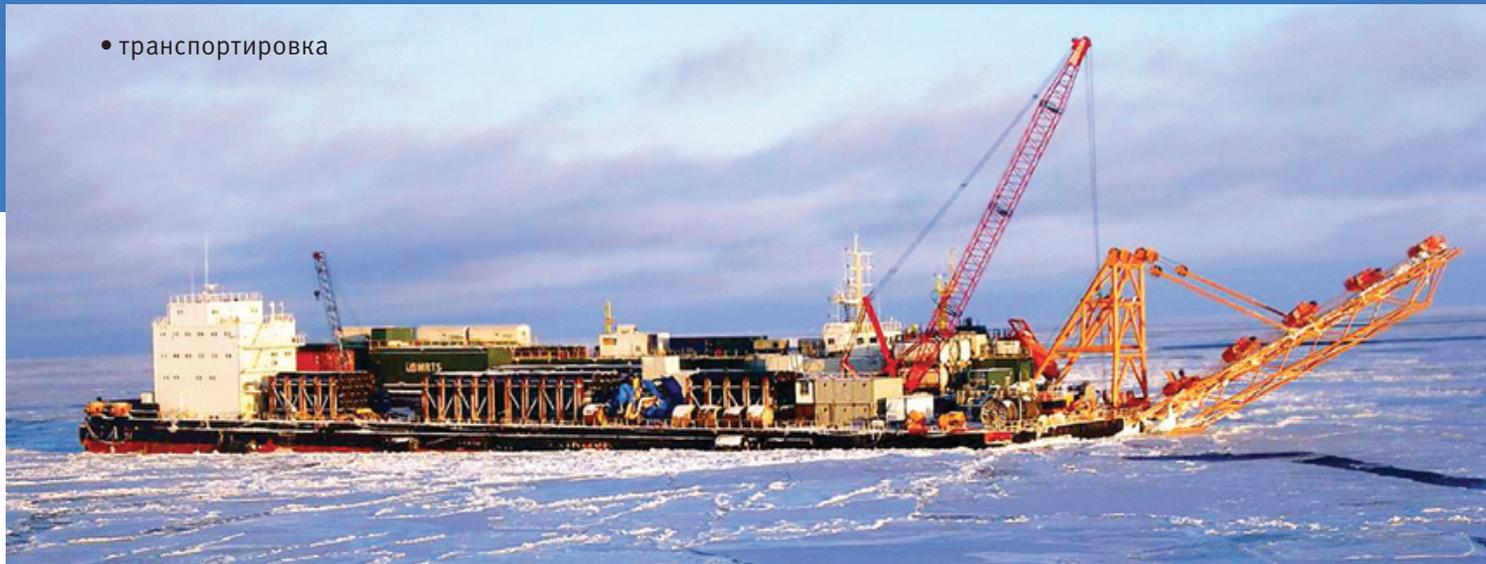
Строительство осуществляется с помощью современного трубоукладочного судна MRTS Defender, предназначенного для создания морских газопроводов и модернизированного специально для работы в Байдарацкой губе
