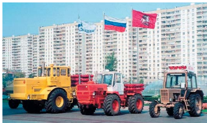
Тракторы, работающие на природном газе. Положительно зарекомендовали себя на сельскохозяйственных предприятиях Краснодарского края, в Татарии, на Рязанщине
